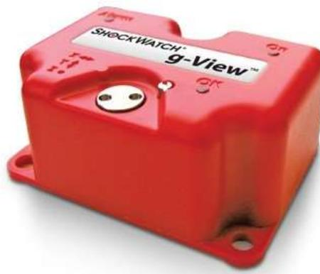
**ShockWatch・IMC Group社のg-Viewは、製品・機器の輸送・保管・使用中に起きた衝撃を検知します。g-Viewを直接に製品または梱包に取り付けると、イベント発生時つまりユーザーが決めた閾値のG値（加速度）を超える衝撃を検知したとき、その日時がg-Viewに正確に記録されます。これにより、製品の所有者は破損・乱暴な荷扱いが起きた正確な日時を特定することができます。**
